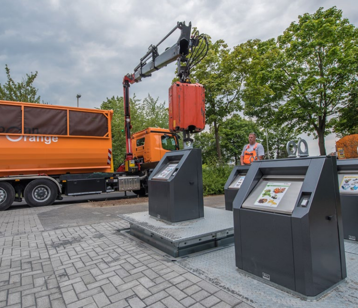
Leerung eines Unterflursammelbehälters auf dem Brüser Berg.
